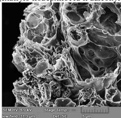
Рис. СЭМ-изображение продукта, полученного сжиганием ксерогеля из нитрата кобальта и лимонной кислоты
